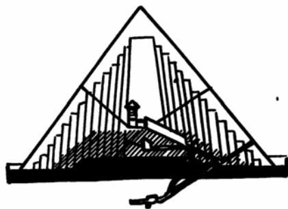
Пирамида Хеопса, 2650 г. до н. э., общий вид. Совершенная геометрия пирамиды. Разрезы пирамиды и разгрузочной системы над усыпальницей фараона
