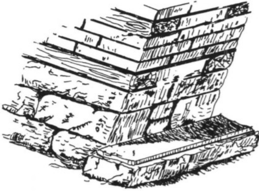
Стена из камня, кирпича и дерева
