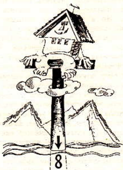
Рис. 138. Здесь другая крайность по сравнению с предыдущим рисунком, но эффект тот же. Чем свая забита глубже и чем она жестче, тем сейсмозащита от нее лучше. В первом случае шло осреднение колебаний по поверхности земли, во втором случае по глубине
