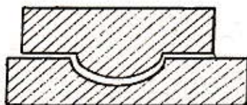
Рис. 123. Соединение камней с помощью полусферических выступов
