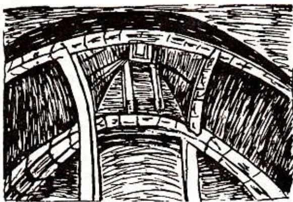
Рис. 75. Арочный каркас для поддержки купола
