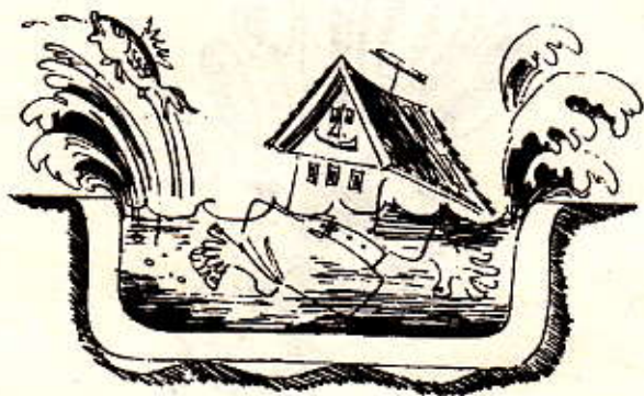
Рис. 132. Хорошим сейсмоизолятором может служить бассейн, наполненный водой или какой-либо другой тяжелой жидкостью, в которой плавает здание в полной уверенности за свою безопасность. Такая сейсмоизоляция в наш век вполне осуществима
