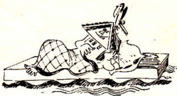
Рис. 137. Большеразмерная, жесткая и массивная плита вполне способна защитить здание от землетрясения: чем плита больше, тем лучше
