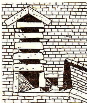
Рис. 15. Разгрузочная система погребальной камеры пирамиды Хеопса
